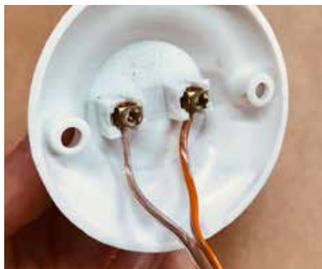
10. Parafuse um fio em cada terminal do soquete.
