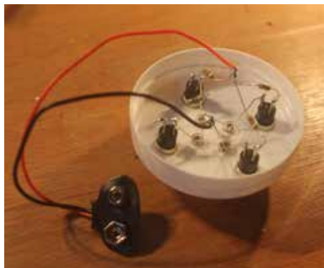
11. Solde o fio preto do clipe de bateria na junção dos negativos dos LED's embaixo.
