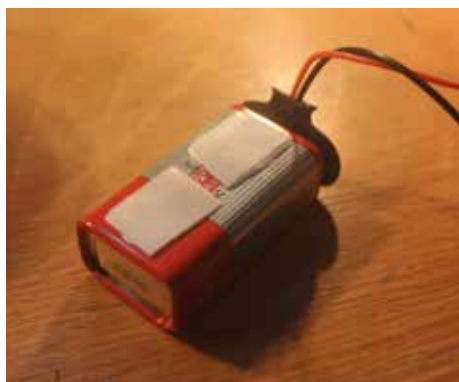
16. Dica: utilize fita adesiva dupla face ou velcro para fixar a bateria no fundo do recipiente, evitando dela se movimentar.
