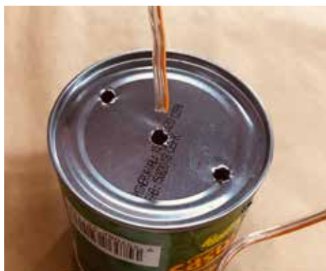
11. Passe a outra ponta do fio pelo furo central da lata, de fora para dentro.
