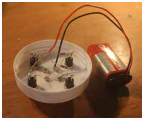
12. Instale a bateria e teste apertando os 4 botões.
