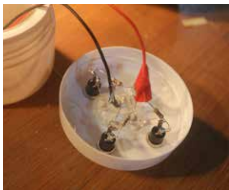
15. Se necessário, utilize também fita isolante, para não deixar as ligações eletrônicas do circuito expostas.
